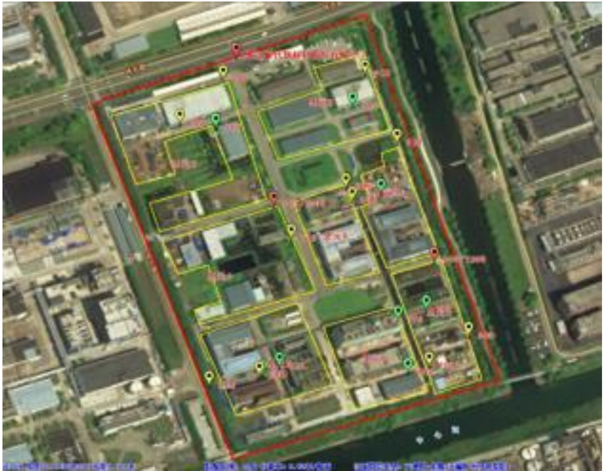
图 7.2-1 土壤和地下水检测布点图
